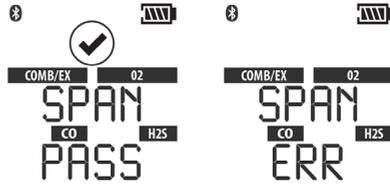
如果某个传感器的使用寿命即将结束，则仪表在显示“SPAN PASS”（量程通过）后还将显示传感器寿命结束警告（♥ 标志）。仪表返回正常运行模式后，♥ 标志以及接近使用寿命的传感器的气体类型将持续闪烁 15 秒。在运行模式中，仪表将持续显示 ♥ 标志。
